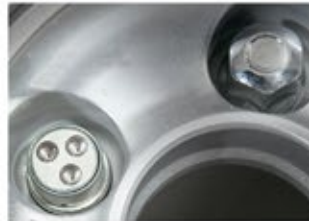
Tornillo sin tapón de acero inoxidable Screw without stainless steel cup
